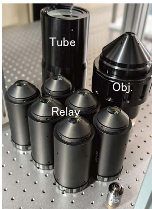
図2 1台の Diesel2p 顕微鏡に使用されるレンズ リレーレンズ6個、チューブレンズ1個、対物レンズ1個。右下が通常の顕微鏡で使用される対物レンズ
